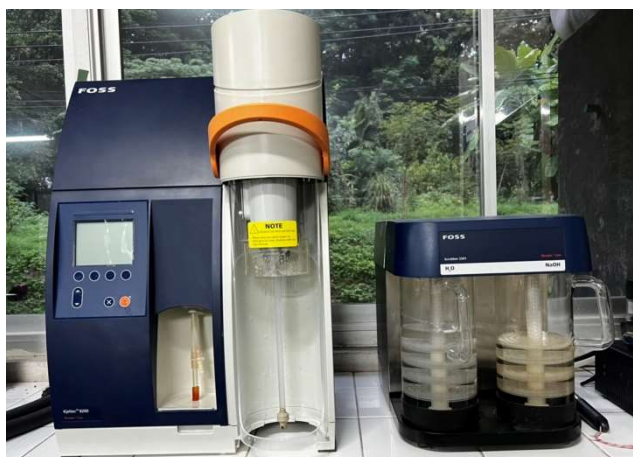
ภาพที่ 8 เครื่องกลั่นโปรตีน/ไนโตรเจนแบบอัตโนมัติ Auto Distilling Unit
